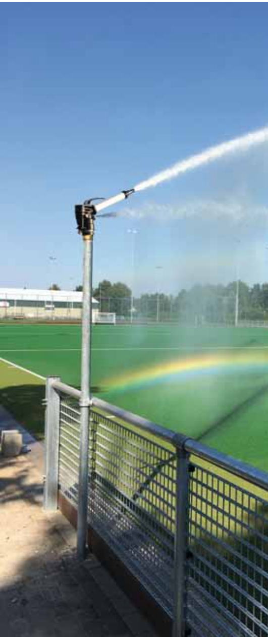
De nieuwe P2Plus-sproeier van Aquaco sproeit op basis van sector in plaats van tijd.
