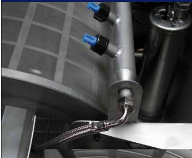
Extra aansluiting met nozzle voor spoelen vuilgoot
